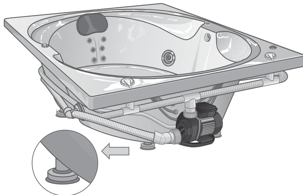
La cantidad de soportes dependen del diseño de la tina y la superficie en donde se va a instalar.
