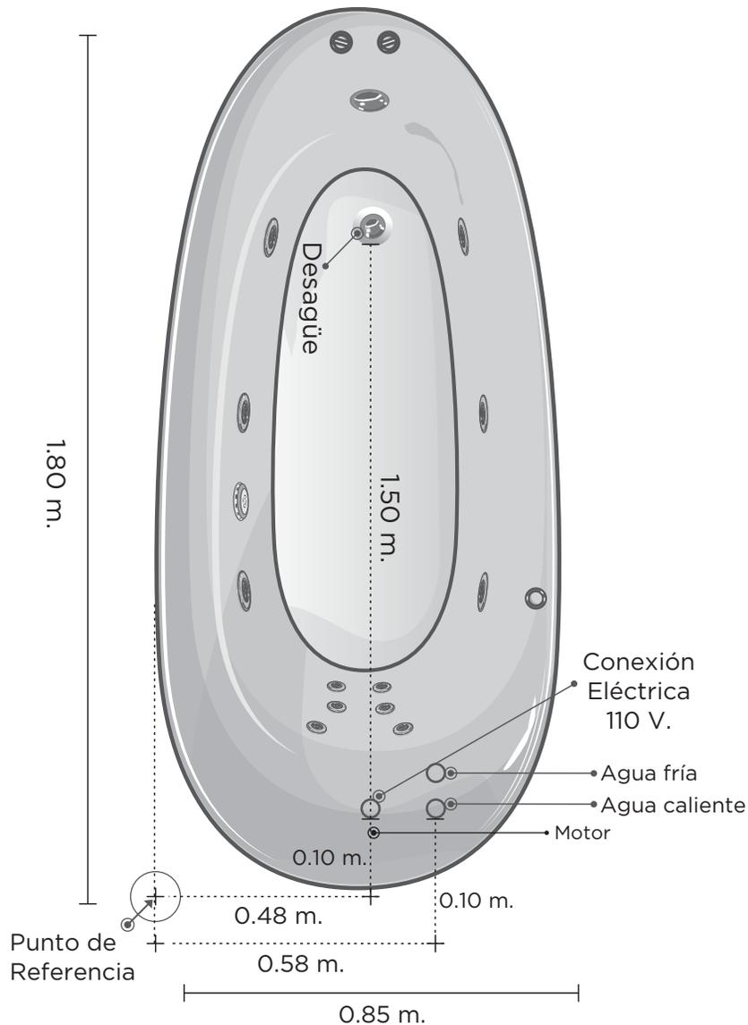
Será necesario proporcionar tres elementos importantes y al alcance del área del equipo para el funcionamiento de la tina.
