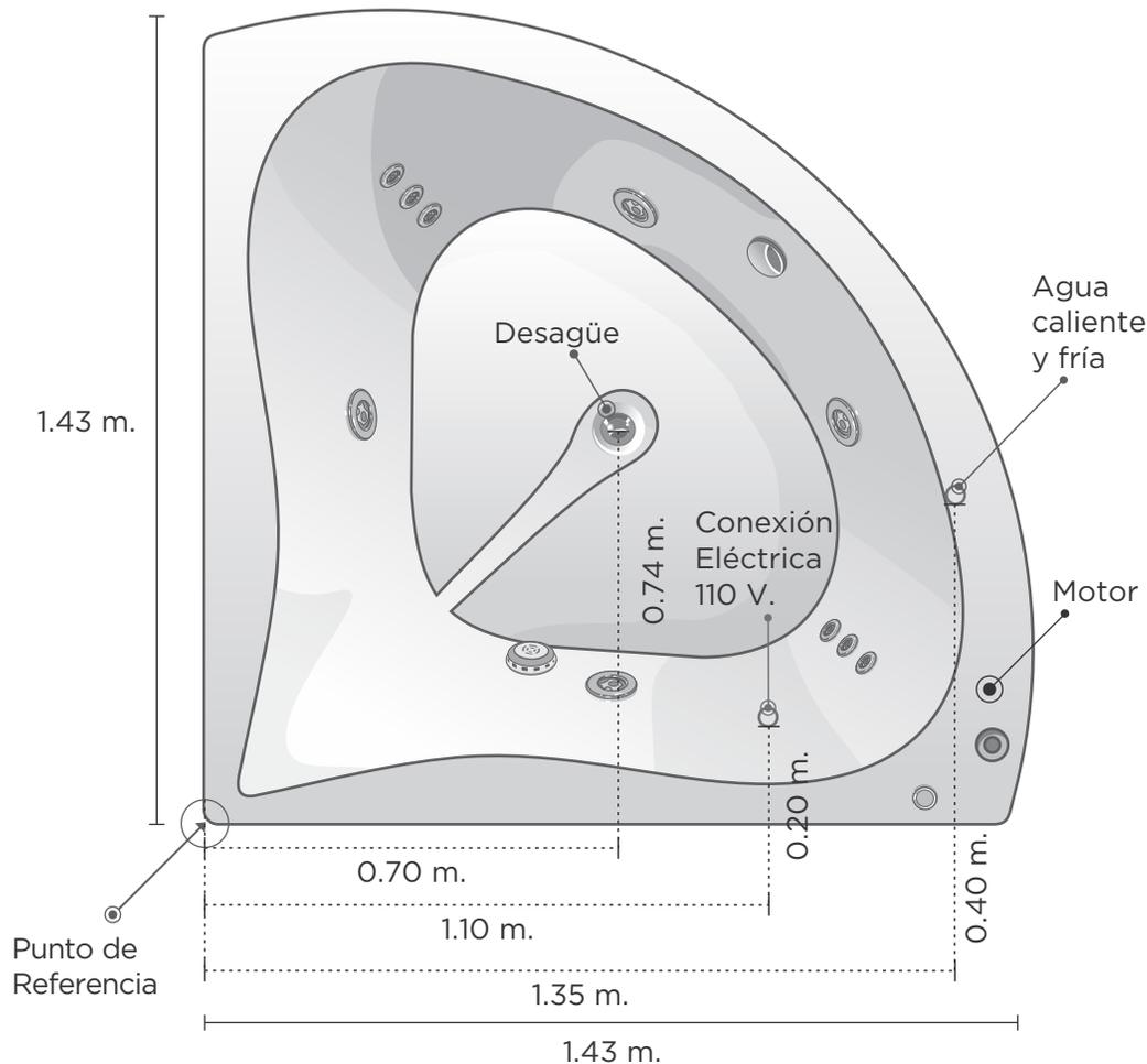
Será necesario proporcionar tres elementos importantes y al alcance del área del equipo para el funcionamiento de la tina.
