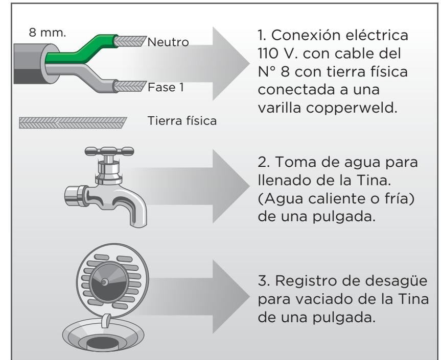
El cliente deberá considerar que el agua fría y caliente ya deben estar mezcladas y controladas por medio de llaves separadas o un monomando para ser conectadas al jet de llenado de la tina de hidromasaje.
