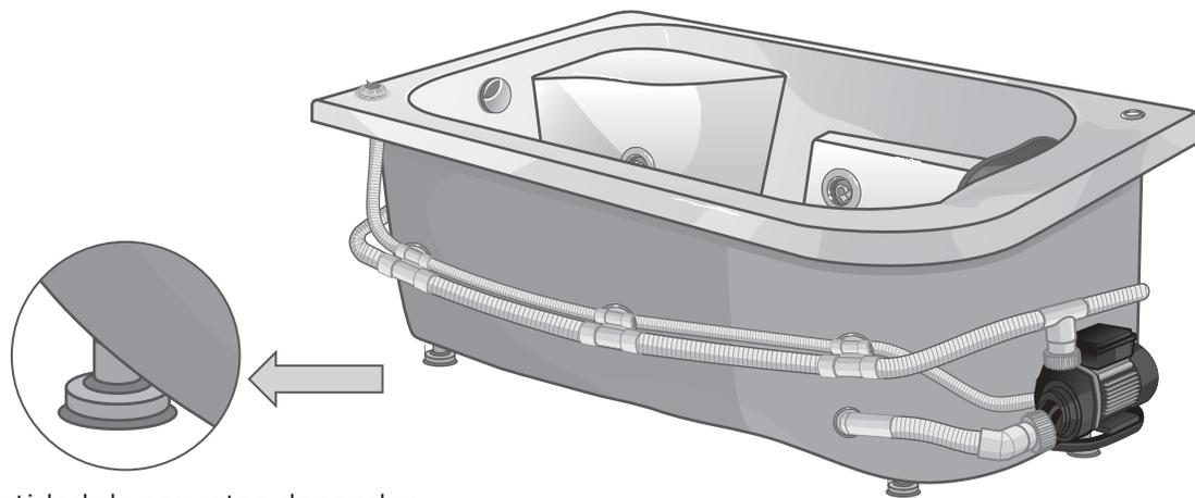
La cantidad de soportes dependen del diseño de la tina y la superficie en donde se va a instalar.
