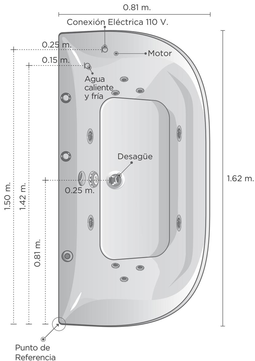
Será necesario proporcionar tres elementos importantes y al alcance del área del equipo para el funcionamiento de la tina.
