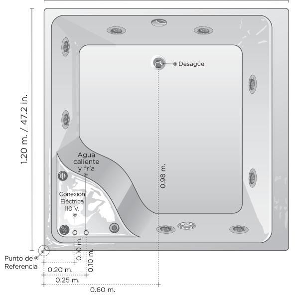
Será necesario proporcionar tres elementos importantes y al alcance del área del equipo para el funcionamiento de la tina.
