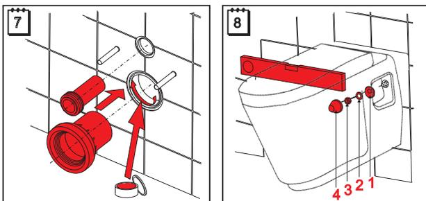
Coloque el desague en la tasa y al muro y coloque el WC al muro y atornille el muro
