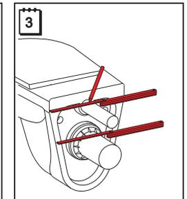
Antes de instalar el WC debe retirar el cubre polvo de los preparativos del modulo del tanque oculto coloque el desagüe al muro y marque a nivel de muro.
