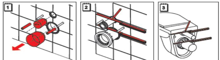
Antes de instalar el WC debe retirar el cubre polvo de los preparativos del modulo del tanque oculto coloque el desague al muro y marque a nivel de muro.
