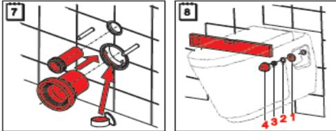
Coloque el desague en la tasa y al muro y coloque el WC al muro y atornille el muro
