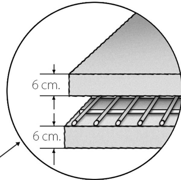
La ilustración muestra la forma en la que debe armarse el firme. Es necesario colocar dos capas de colado de un espesor de 6 cm. una arriba de otra, reforzada en su interior de un tramado metálico.
