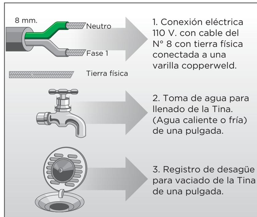
El cliente deberá considerar que el agua fría y caliente ya deben estar mezcladas y controladas por medio de llaves separadas o un monomando para ser conectadas al jet de llenado de la tina de hidromasaje.
